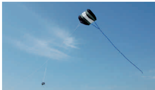
Abb. 2: Kite Aerial Photography: Die Kamera wird an der Flugleine eines Einleinerdrachens mit einer Seilpendelaufhängung (Picavet) befestigt. Der abgebildete Drachen ist eine Kap-Foil von 3 m 2 Größe. Der steile Leinenwinkel erlaubt eine gute Manövrierbarkeit um hohen Gebäuden und Bäumen auszuweichen (Quelle: J. Benedix).
